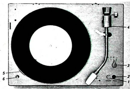
Bild 2. Oberseite des „PS 1000“ mit Bedienelementen: 1. Tonarm absenken — heben, 2. Antrieb Ein — Aus, 3. Drehzahlwahl, 4. Auflagekraft-Einstellung, 5. Siroboskop, 6. Drehzahlfeineinstellung
